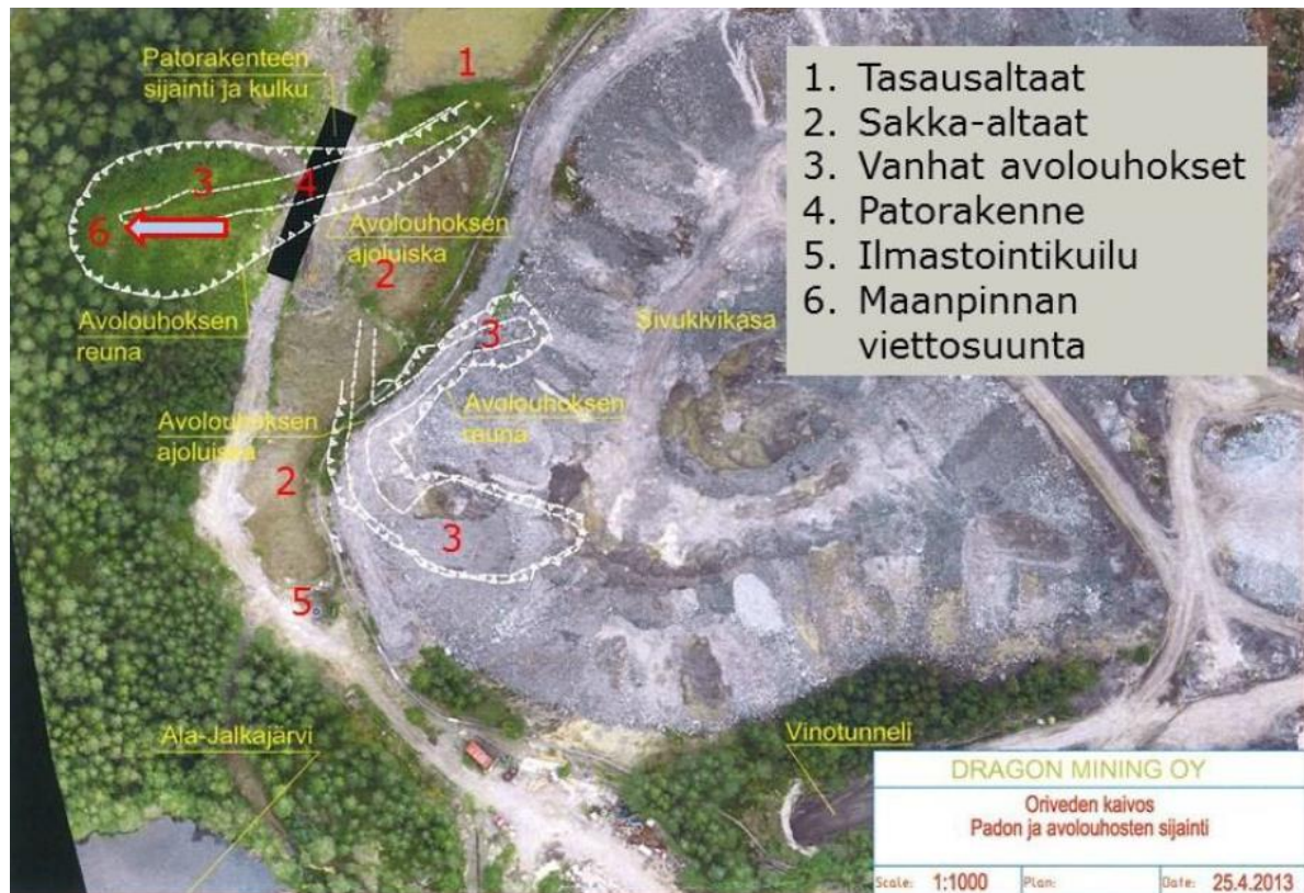
Kuva 11. Länsireunan laajennusalueella olevat rakenteet.
